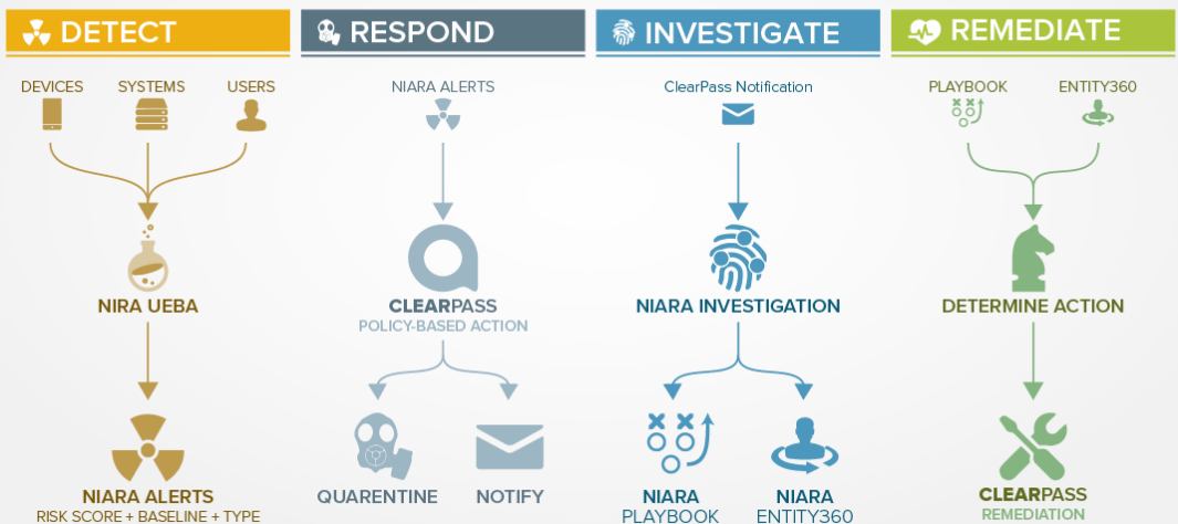
Gambar 7. Kolaborasi Aruba ClearPass dan Niara UEBA terhadap perangkat IoT
